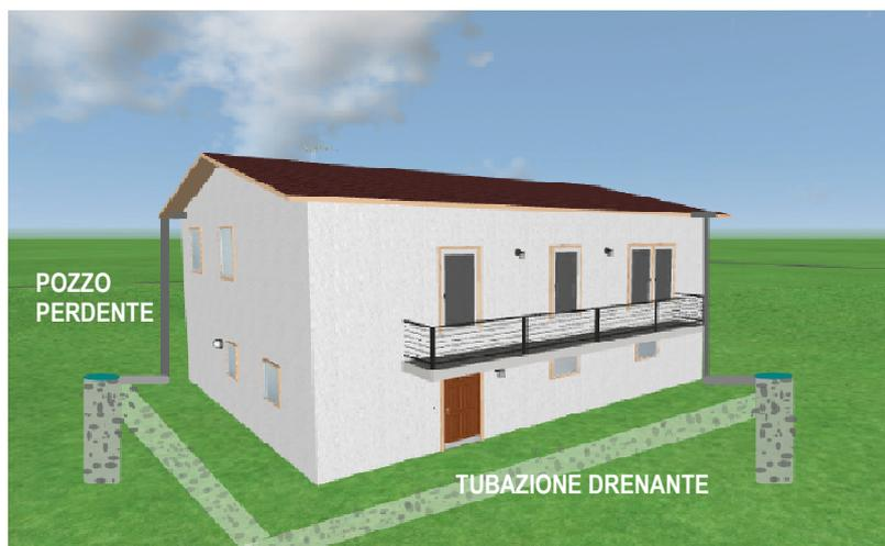
Schema di impianto dei pozzi perdenti per edificio singolo
